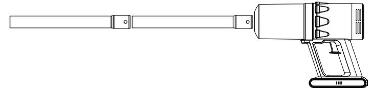
Ühendage ühendustoru pörandaharjaga, nagu joonisel näidatud, sisestage see õigele sügavusele ja keerake kinni. Seadme külge saab paigaldada harja, mida kasutatakse pörandi ja muude esemete puhastamiseks.
