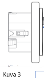
Pääkytkin ylhäällä = 0 tila Pääkytkin alhaalla = I tila
